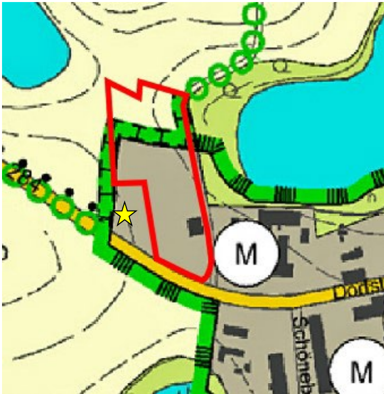
Abb. Auszug aus der Planzeichnung zum wirksamen Flächennutzungsplan mit Kennzeichnung des Geltungsbereiches des Bebauungsplans (rote Markierung/unmaßstäblich) und Markierung der Teilfläche mit Entwicklungsalternativen (gelbe Stern-Markierung) Quelle: © Amt Oder-Welse 2021 | © GeoBasis-DE/LGB 2021, dl-de/by-2-0 ( https://www.govdata.de/dl-de/by-2-0/ )
